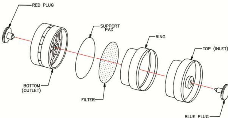
Le cassette 3 pezzi sono più flessibili perché possono essere utilizzate per campionamenti a faccia chiusa e per campionamenti a faccia aperta e possono essere connesse a cicloni. Il principale svantaggio può essere che una cassetta a 3 pezzi ha più superficie con cariche elettrostatiche rispetto a una cassetta a 2 pezzi causando una potenziale perdita nel campionamento.
