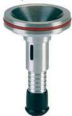
Il suo supporto, munito di clip, senza ciclone può essere utilizzato come supporto per cassetta portafiltro. Le polveri respirabili vengono raccolte sulla membrana posizionata nella cassetta e le polveri grossolane vengono raccolte nel serbatoio al fondo del separatore in alluminio.
