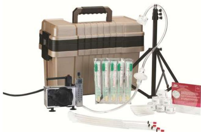
Per il Campionamento di IAQ, *Zefon* è in grado di offrire dei comodi "Starter Kit", completi di tutto quanto necessario per eseguire questo tipo di interventi.
