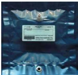
Le sacche per campionamento gas *Zefon Foil Bag*, con la loro speciale copertura, permettono di raccogliere campioni di sostanze fotosensibili. Ideali anche per campionare gas di scarica o sostanze instabili al tradizionale tedlar.
