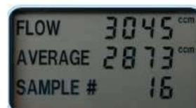
Semplice microprocessore di controllo di facile operatività, con pulsanti on/off e reset, ampio schermo LCD indicante i dati di flusso, il calcolo della media e il numero dei campioni.
