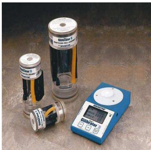
Il *Gilibrator 2* è un Calibratore **PRIMARIO a bolla di sapone** con controllo elettronico utilizzato per la taratura della portata dei campionatori personali ed ambientali.
