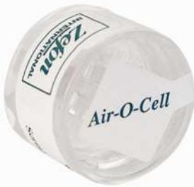
L' *Air-O-Cell* è l'unica cassetta di campionamento studiata per la raccolta rapida di un'ampia quantità di sostanze aero-allergeniche, tra cui: spore di muffe, pollini, parti di insetti, frammenti di pelle, fibre e polveri inorganiche.
