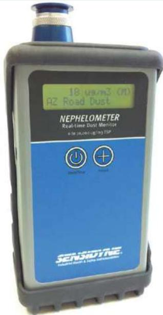
Il Sensidyne RTD ("Real Time Dust") monitor utilizza la tecnologia "light scattering" fornendo in tempo reale la concentrazione di polveri totali (TSP). **La versione Deluxe permette la misura anche di PM10, PM2,5, PM4** con relativi impattori
