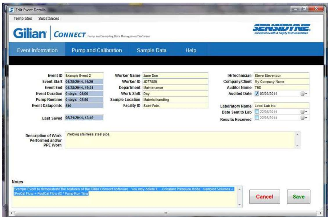
Su **Event information** vengono visualizzati i dati di ciascun campionamento: Identificativo, nome dell'operatore, ora/giorno di inizio e di fine, durata del campionamento, ecc. E' possibile già in questa fase riportare il nome del Laboratorio al quale verrà inviato questo campione, e la data del conferimento. Sui Report è possibile inserire il proprio logo aziendale.
