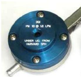
L'Harvard Personal Exposure Monitor (H-PEM) è stato sviluppato dal Dipartimento di Scienze dell'Università di Harvard e consiste in un set di 4 diversi presettori per campionare PM10, PM2,5 o PM4 a diverse portate di aspirazione.
